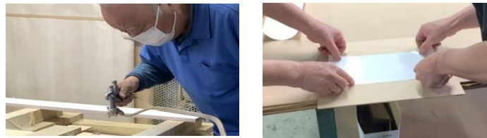
手作業でシート接着をしていきます
